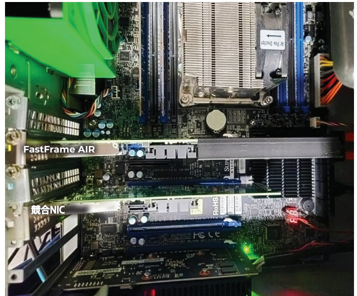
AワークステーションのPCIeスロットに搭載されたATTO FastFrame AIR（下段：競合NIC）AIRバッフル技術により、FastFrame AIRはハーフハイト/3/4レングス設計となっており、ほとんどのワークステーションおよびサーバー筐体に適合します。
